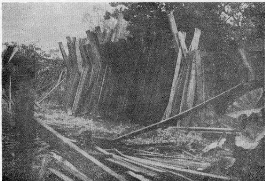
Fig. 2. Secado al aire libre de madera aserrada de diversas especies de baja densidad. La madera está en contacto directo con el suelo y rodeada de malezas y desperdicios, lo que reduce la velocidad de secado y favorece el ataque a la madera por hongos e insectos.
